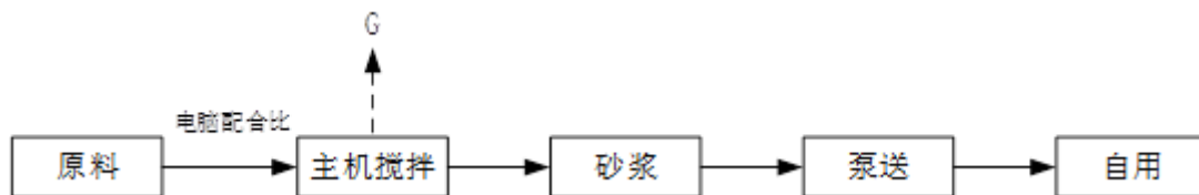
图 2-1 本项目商品混凝土生产工艺流程及产污环节图 (G-废气)
